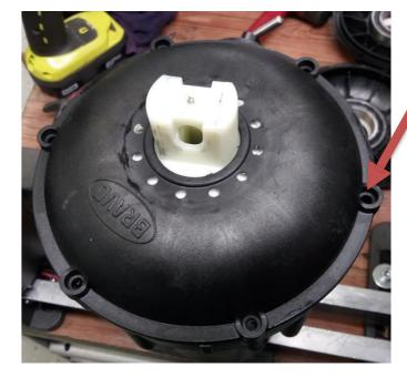
2. Demontage des Motorbolzens: 2 x Schraube (torx T30) nach 180°
