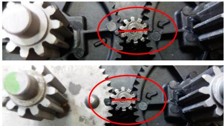
Hinweis: Für ältere Versionen von Motokarre beide Ritzel aus Kunststoff m1,25 – PA 6,6 mit 60 % Glasfasern, strahlenvernetzt, verwendet – für die anderen Motokarres wird eine Hybridkombination = 1 nitriertes Stahlrad + 1 Kunststoffrad aus PA 6.6 mit 60 % Glasfasern, strahlenvernetzt
