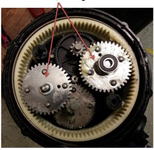
Beim Einlegen der eingelegten Zahnräder kann die Box so bewegt werden, dass die am besten geeignete Position für das eingesetzte Rad gefunden wird (es sollte sich leicht mit der Hand zwischen die Zähne des Ritzels und die Zähne des Freilaufs drücken lassen)
