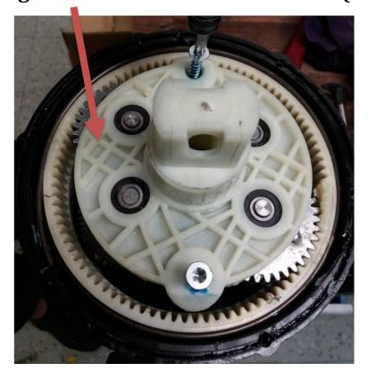
Alle Schrauben sind mit einer Schraubensicherung aus Kunststoff gesichert. Deshalb geht das erste Lösen schwer.
