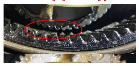
Nach dem Einbau der Zahnräder lässt sich der gesamte Antrieb leicht drehen.
